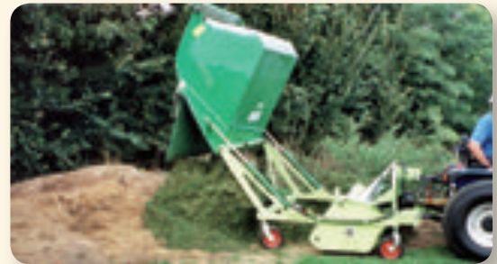
Scarico idraulico del raccolto. Hydraulic catcher discharge view. Bennage hydraulique du produit ramassé. Hydraulischer Sammelbehälter - Entleerungsansicht.
