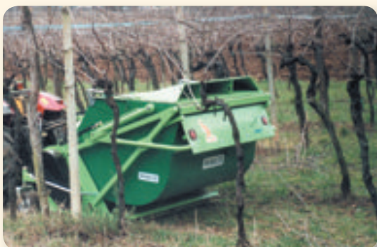
Ottime prestazioni di taglio e raccolta di erba e rami fino a 5 cm Ø. Great performance on grass cut and pruning shredding up to 5 cm Ø Bonne performance de coupe et de ramassage d'herbe et sarments max. 5 cm Bestes Mulchergebnis, perfekte Aufnahme auch im hohen Grass mit bis 5 cm Ø
